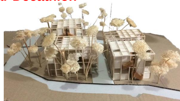
Vivienda multifamiliar modular LEGO – pórticos estructurales y paneles de cerramientos en bambú guadua laminada Multifamily modular LEGO housing – structural frames and enclosures panels in laminated bamboo guadua
