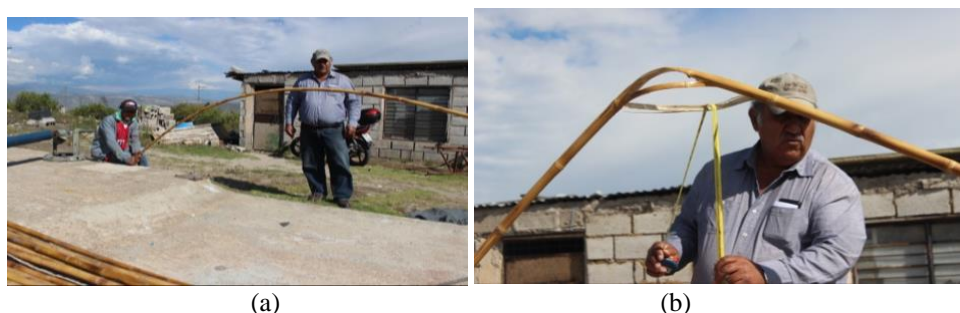
Figura 11: (a) Ensayo para la obtención de la altura máxima de la curva en culmo de Phyllostachys , (b) Rotura del culmo en la cuarta aplicación de fuerza en carga axial
