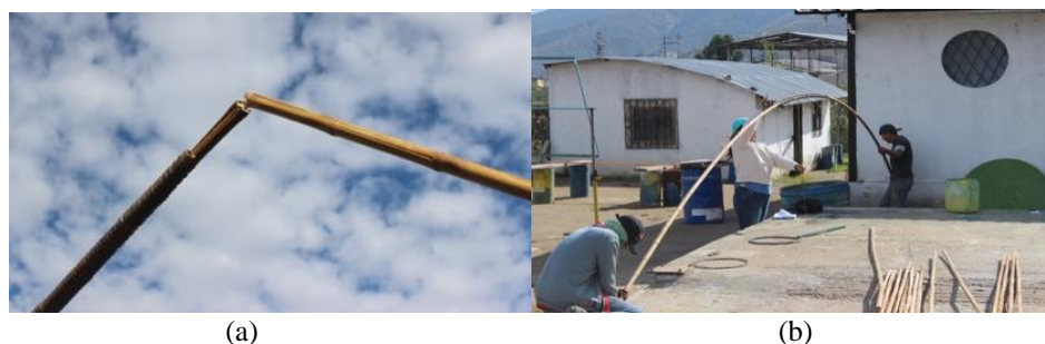
Figura 12: (a) Primer testigo traslapado: Rotura del culmo a 25 cm del traslape, (b) Segundo testigo traslapado: Medida de altura máxima en el centro del arco.
