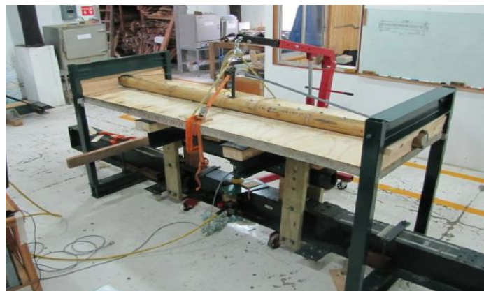
Figura 4. - Foto de un ensayo de una vigüeta con una cubierta de concreto de 5cm de espesor.
