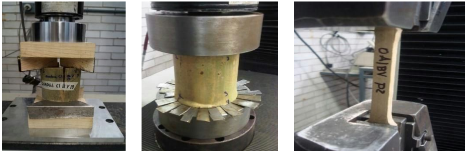
Ensayos de cortante, compresión y tracción de bambú
