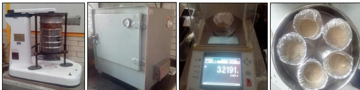
Equipo de cribado, horno de secado, control y clasificación de las fibras de bambú
