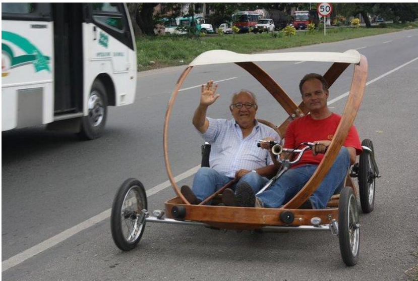
Foto: El “Bamboo Buggy” eléctrico, el marco es una sola cinta de guadua laminada.
