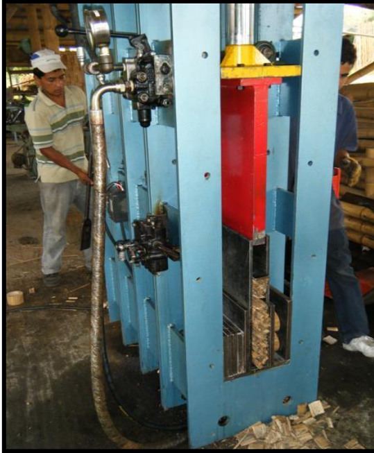
Foto: Prensa experimental con 100kg/cm 2
