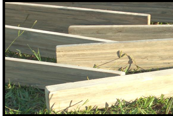
Foto: Vigas de Guadua laminada
