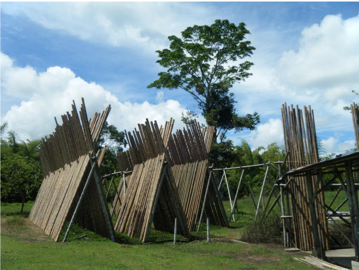
Foto : Guadua inmunizada con bórax, expuesto para secar y adquirir el color amarillo.
