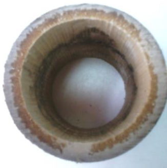
Fig. 5. Vista del corte transversal de culmos de bambusa Guadua Angustifolia infiltrados con el polímero experimental.
