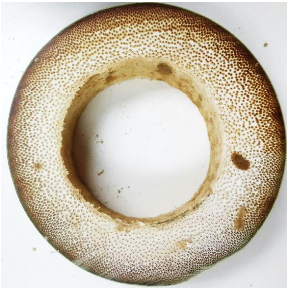
Fig. 2. Vista simple del corte transversal de un culmo de bambú. Pueden observarse los vasos capilares dentro de toda su estructura.
