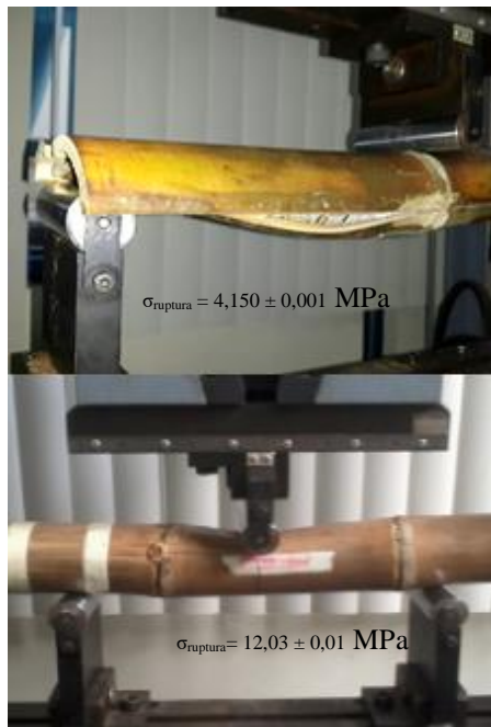
Fig. 8. Efectos del ensayo de flexión sobre probetas sin (arriba) y con (abajo) tratamiento preservante a base de resina de poliéster.
