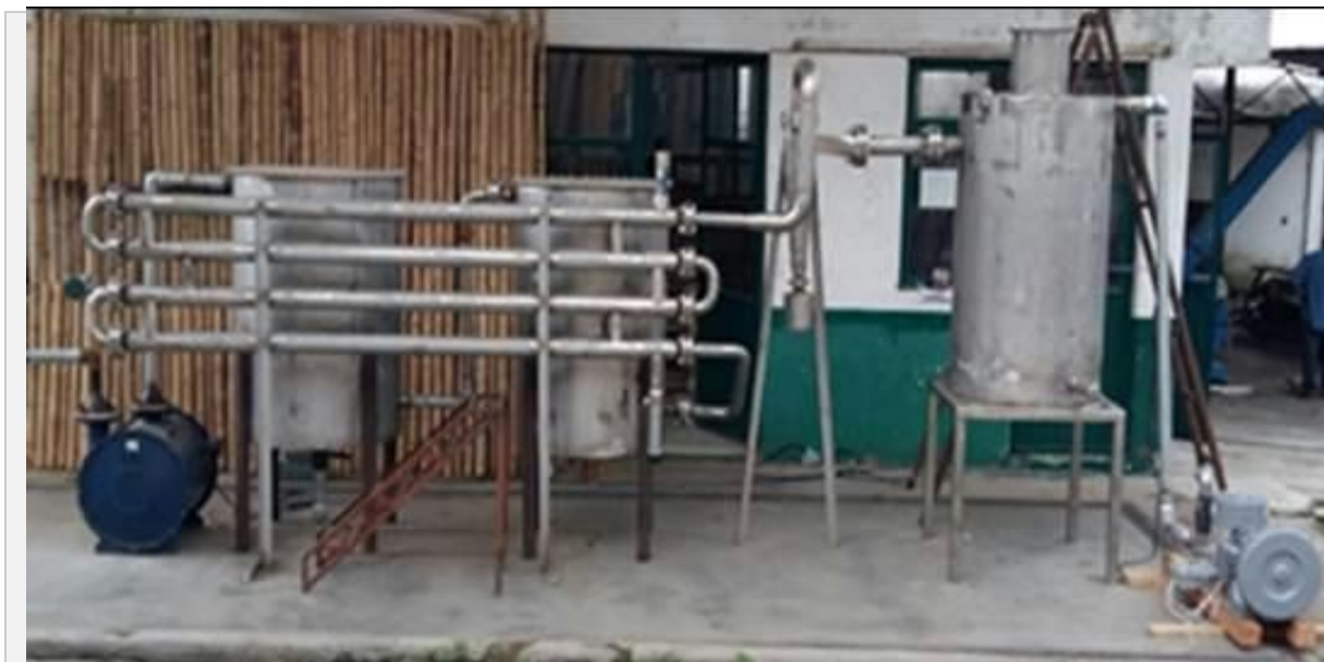
Figura 1. Prototipo para la gasificación de bambú.
