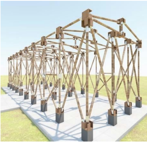
Esqueleto de la estructura de muros y techo plegable de bambú
